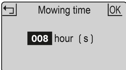
Это количество времени в день, в течение которого газонокосилка будет работать. Оно включает время зарядки. Например, если установлено значение 8 часов, а газонокосилка настроена на работу с 20:00, она будет работать до 4:00 утра. В это время она может косить 1 час, заряжаться 2 часа, снова косить 1 час; затем заряжаться 2 часа, косить в течение 1 часа и снова вернуться на зарядку для подготовки к следующему циклу.
